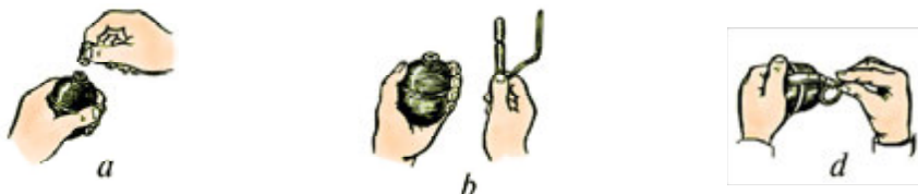
114-rasm. Parchalanuvchi qo'l granatalarining jangovar holati: a — probkani burab olish; b — zapalni olish; d — zapalni burab o'rnatish.
