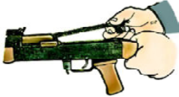
109-rasm. Qaytaruvchi mexanizmni ajratish.
