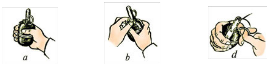
115-rasm. Granatani uloqtirish oldidan harakatlantirish: a —granata korpusi bilan birgalikda boshlovchi richagni qisib ushlab; b —qo'riqlagich oldi cheki oxiridan ushlab to'g'rilash; d —qo'riqlagich chekini uzib olish.
