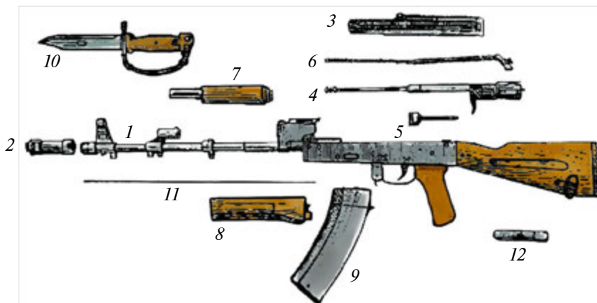
90-rasm. Avtomatning asosiy qism va mexanizmlari: 1—stvol, stvol qutisi, zarbdor-tepki mexanizm, mo'ljalga olish moslamasi, qo'ndiq va pistolet dastasi bilan birga; 2—olov so'ndiruvchi-kompensator; 3—stvol qutisining qopqog'i; 4—zatvor ramasi gaz porsheni bilan birgalikda; 5—zatvor; 6—qaytaruvchi mexanizm; 7—gaz trubkasi stvol qoplamasi bilan birgalikda; 8—stvol osti dastasi; 9—magazin; 10—nayza-pichoq; 11—shompol; 12—tozalash anjomlari uchun penal.
